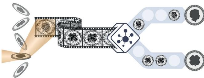
Das Prinzip von Coherent Correlation Imaging zur Abbildung eines zufälligen Prozesses – hier symbolisch eines Münzwurfs. Eine einzelne kurze Aufnahme der Münze ist zu schwach belichtet, um das Bild auf der Münze zu erkennen. Ein neuer Algorithmus kann die Bilder aber sortieren und kombinieren, um daraus Bilder der beiden Seiten der Münze zu entwickeln und zeitlich der Filmaufnahmen zuzuordnen.
