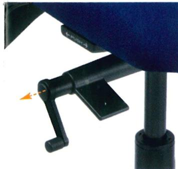
Passen Sie mich Ihrem Körpergewicht an. Ziehen Sie hierzu die Kurbel rechts am Griff heraus. Verändern Sie den Gegendruck im Rücken entsprechend Ihrem Körpergewicht. Drehen im Uhrzeigersinn erhöht den Gegendruck. Drehen gegen den Uhrzeigersinn reduziert den Gegendruck. Mein Einstellbereich liegt zwischen 45 und 120 kg Körpergewicht. Nach der Einstellung schieben Sie die Kurbel wieder nach innen, so stört diese Sie nicht bei der Bewegung.
