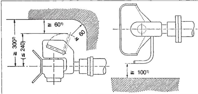
zu 1) Die Maße  $\geq 60$  mm und  $\geq 100$  mm (Handhebel freiraum) gelten grundsätzlich für alle Arten von Bolzenkupplungen und Anbausituationen. Für Bolzenkupplungen mit nach abwärts gerichtetem Handhebel gilt das Maß  $\geq 60$  mm sinngemäß (hier: nach unten).
